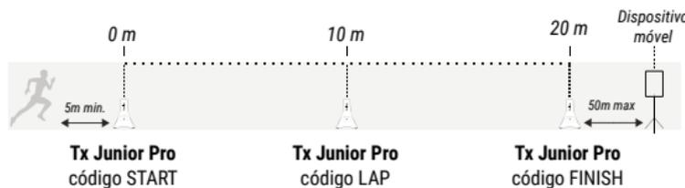
**⚠** Posicionar os transmissores em qualquer outra localização ou posição, pode resultar em imprecisões ou em não deteção.
