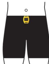
▶ Befestigen Sie Ihren FxChip BLE am Gürtel der Hose des Athleten mit dem Befestigungsclip (mitgeliefert). Er muss unbedingt an der Taille befestigt, **mittig in der Ausrichtung des Bauchnabels zentriert** und vertikal positioniert werden.
