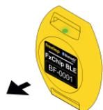
Activez votre FxChip BLE: Placez-le à la verticale et secouez-le horizontalement. La led verte confirme que l'appareil est activé.
